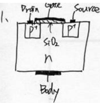
在 n structure 打入 2 處 P, 拉出導線作 Drain, Source
