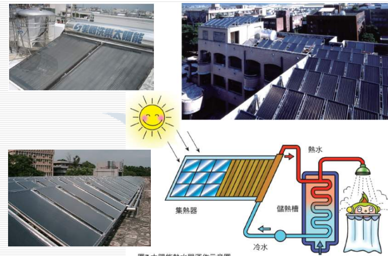
圖7 太陽能熱水器運作示意圖
