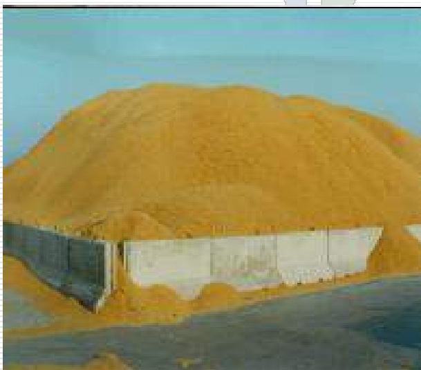
泰國一座2.5MW蒸汽渦輪稻殼發電廠，1997年運轉，每小時處理17噸。 圖片取自：COGEN3 website, EC-ASEAN COGEN Program, http://www.cogen3.net/
