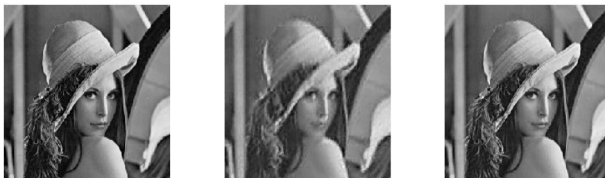
圖 8: 左邊為 256x256 的 Lena 原圖，中間為壓縮圖採 q = 16 (壓縮比 8 倍)，右邊採 q = 64 (壓縮比 2 倍)
